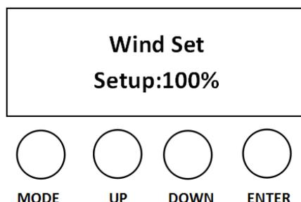
Рисунок 3. Дважды нажмите кнопку MODE, на дисплее появится надпись «Wind Set», нажмите кнопку UP или DOWN, чтобы отрегулировать мощность ветра в диапазоне от 1% до 100%.
