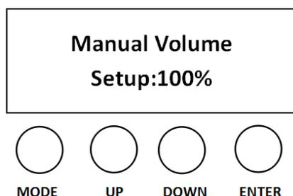
Рисунок 2. Нажмите кнопку MODE один раз, на дисплее появится надпись «Manual Volume», нажмите кнопку UP или DOWN для регулировки подачи снега в диапазоне от 1% до 100%.
