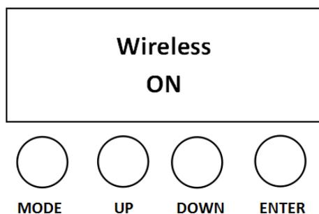
Рисунок 6. Нажмите кнопку MODE пять раз, на дисплее появится надпись «Wireless», нажмите кнопку UP или DOWN чтобы включить или выключить режим беспроводного управления.
